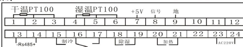
注: 打印机接口接线, ‘R’即为打印机并排的第‘21’线, ‘T’即为打印机并排线的第‘19’线, ‘地’即为打印机并排线的‘10-18、20、22-24’线。多余排线不用接。
