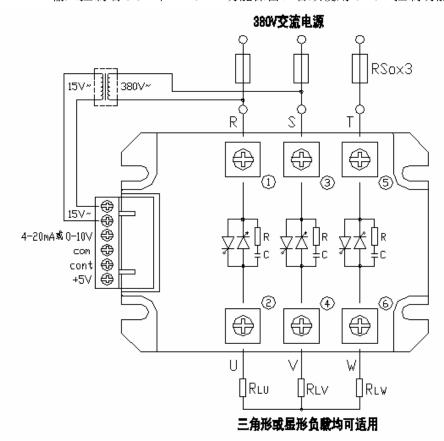
9、模块自动判别相序,电路的进线 R、S、T 无相序要求。三相输出电压对称性较好,正常情况下三相输出误差不大于 $\pm 5V$ ~。若偏差稍明显,请检查三相进线 R、S、T 电压是否一致,也可将三相进线中 R、S、T 任两路调换即可。
